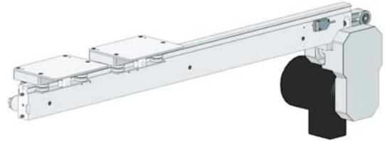
Die Bandstrecken werden für den Transport der Werkstückträger zwischen zwei Arretierstationen eingesetzt. Sie sorgen für eine Entkopplung der einzelnen Zellenmodule und dienen gleichzeitig als kleine Puffer außerhalb der Bearbeitungsstationen. Die Mitnahme der Werkstückträger erfolgt durch Reibschluss auf einem Transportriemen. Zur individuellen Layoutgestaltung stehen die Bandstrecken in verschiedenen Längen zur Verfügung.
