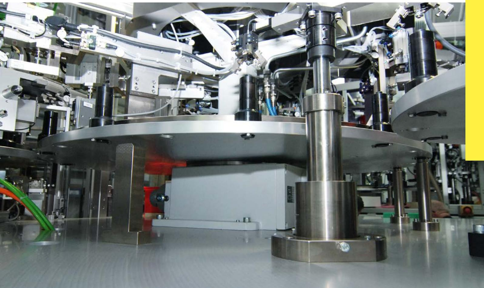
Sondermaschine für einen Automobilzulieferer: Ein frei programmierbarer NC320 ist das Herz der Anlage. Er führt Dichtung und Federn zusammen und übergibt die Bauteile an die anderen Tische.
