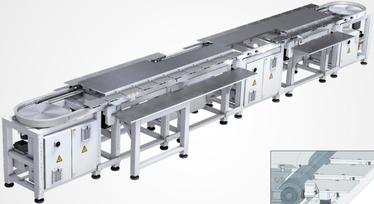
Linearmontagesystem LS 280 bestehend aus vier Montagezellen mit Arretierstation und Grundgestell, sowie aus Bandstrecken, Eckumlenkungen und Werkstückträgern.
