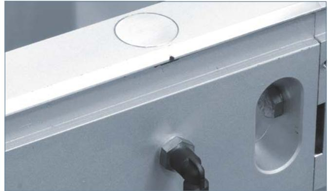
Schmierstelle in Führungsschiene
