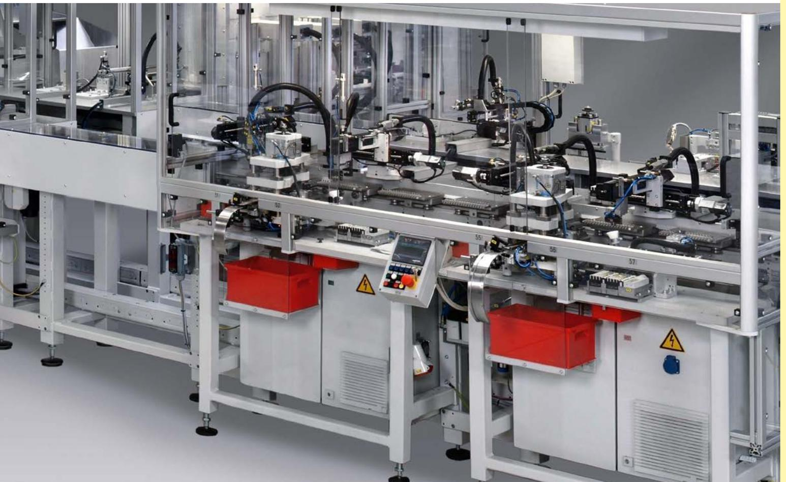
Die Vorteile des LS 280 resultieren aus einem eleganten Antriebsprinzip. Es vereint Rundschalttisch mit Transfersystem, also Kurvenantrieb und Bandsystem. Mit dem Ergebnis einer radikalen Verkürzung der Transportzeiten sowie einer enorm hohen Produktivität. Das modular aufgebaute Zellenkonzept ermöglicht zudem eine flexible und erweiterbare Anlagengestaltung.
