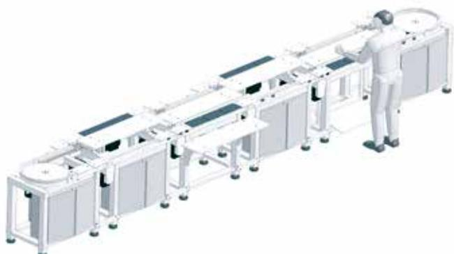
Le châssis de conception stable en acier constitue la base des stations d'indexage du système d'assemblage linéaire LS280. Les modules de manipulation sont installés directement sur les stations d'indexage et ne nécessitent pas de plateforme de support supplémentaire.
