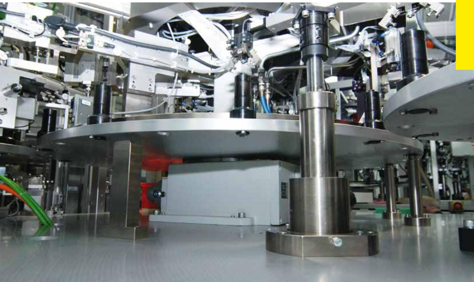
Machine spéciale destinée à un sous-traitant automobile : une NC 320 librement programmable est la pièce maîtresse de l'installation. Elle assemble joint et ressorts et assure le transfert des pièces aux autres tables.
