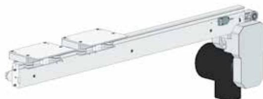
Les convoyeurs à bande servent au transfert des palettes entre deux stations d'indexage. Ils assurent le découplage des différents modules de cellules et font également office de petit tampon en dehors des stations de travail. Les palettes sont entraînées par friction sur une courroie de transfert. Les convoyeurs sont disponibles en différentes longueurs de façon à permettre un aménagement individualisé.
