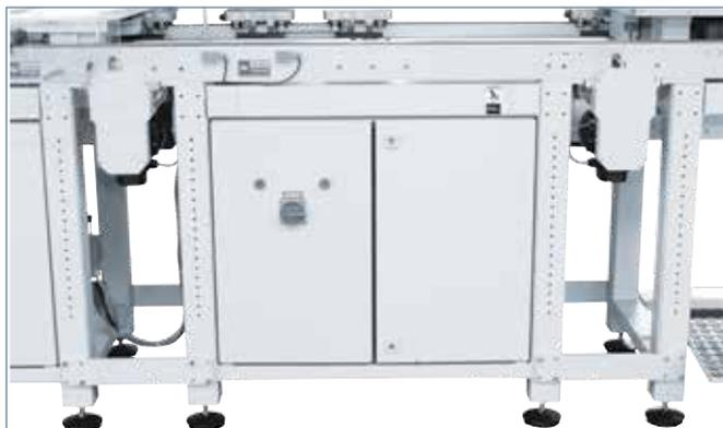
Armoire électrique intégrée dans le châssis
