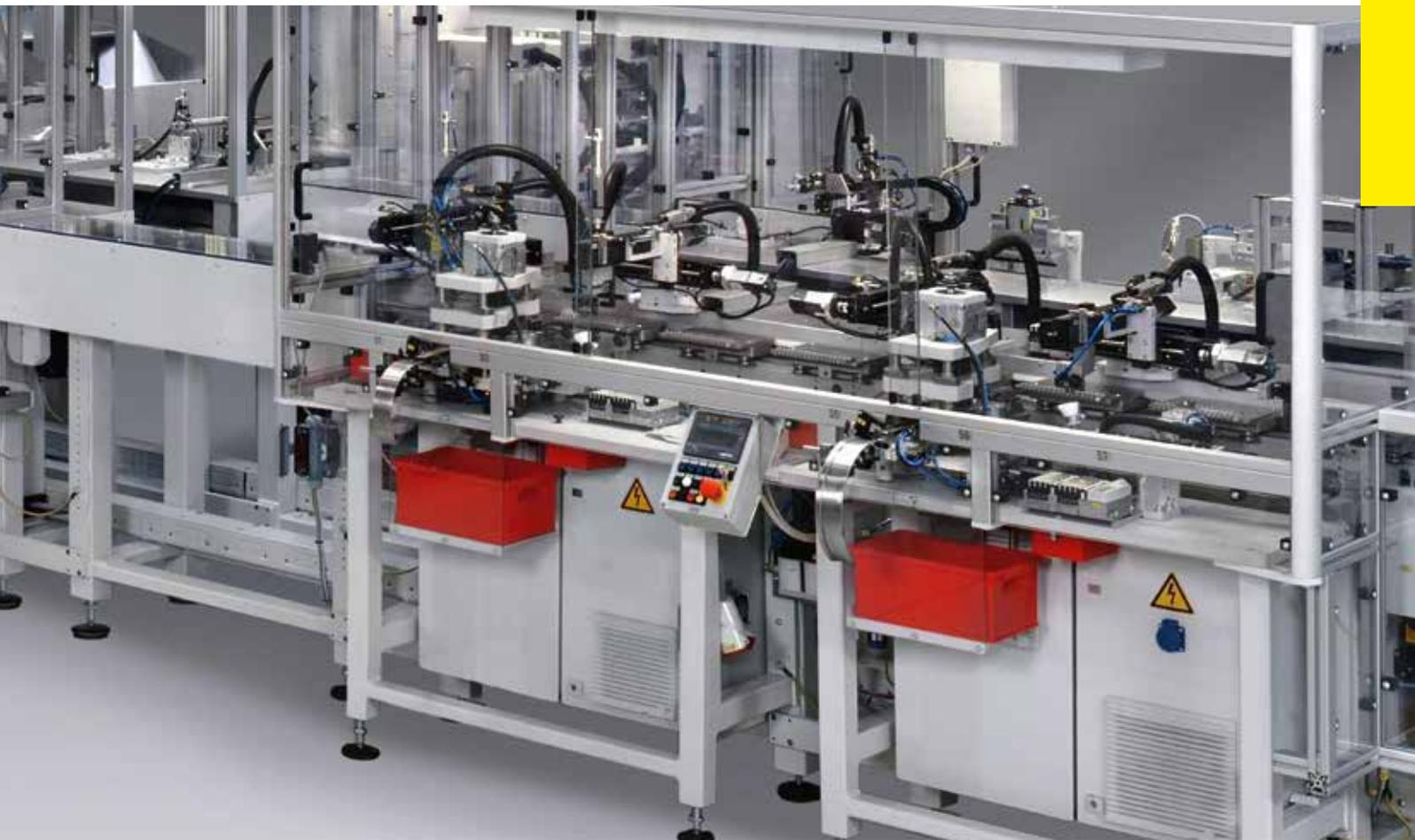
L'avantage du LS 280 résulte d'un mécanisme d'entraînement complètement nouveau. Il combine le principe de la table tournante associé à un système de transfert (système à came et bande de transport). Le résultat obtenu est une très forte réduction du temps de transport procurant ainsi un gain énorme de productivité.
