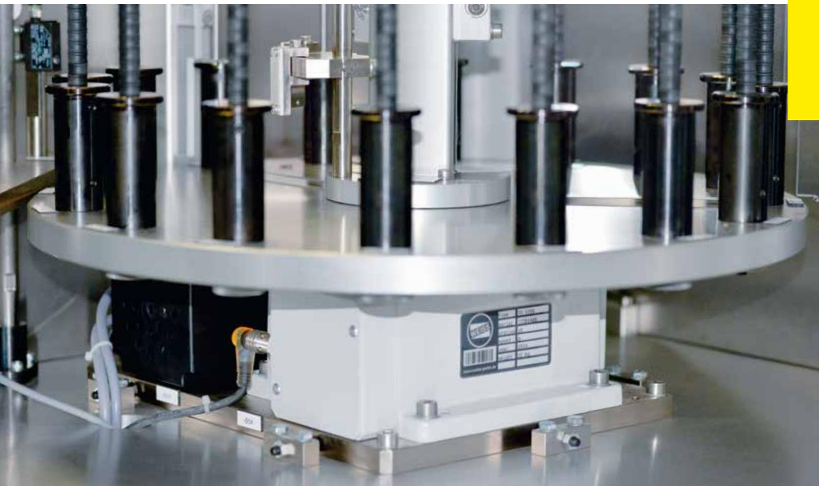
Machine spéciale pour un sous-traitant automobile : le montage de joints toriques pour les pompes à injection requiert une précision maximale. La table tournante TC 150 avec plateau tournant adapté s'en charge également.
