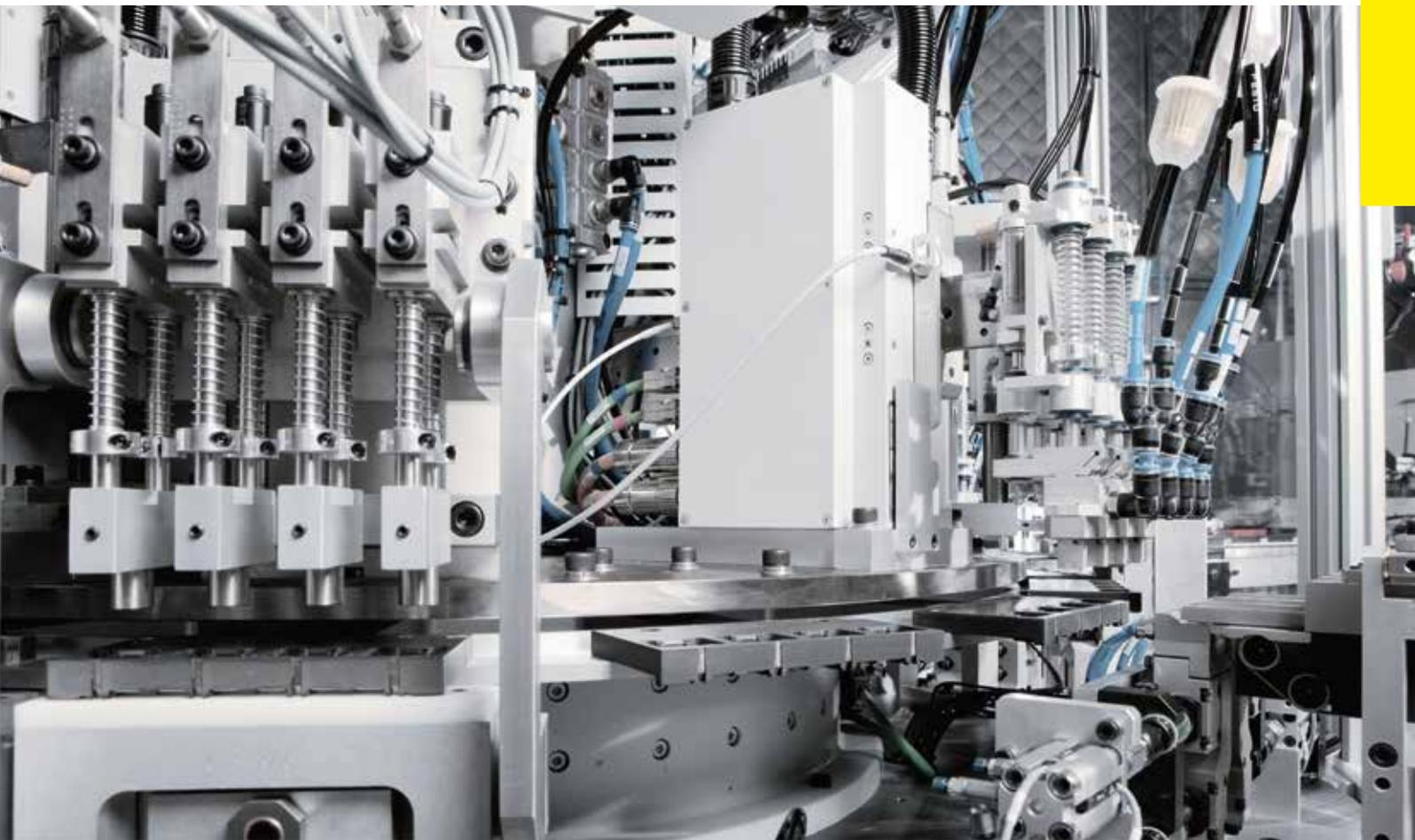
TO – Plateau tournant à entraînement direct, dynamique ultrarapide et haute précision de reproductibilité. Librement programmable et également adapté à l'utilisation en salle blanche. Le plateau tournant à entraînement direct permet des temps d'indexage extrêmement brefs et une précision optimale. La possibilité d'utilisation – et de réutilisation – pour des applications très diverses représente pour vous un potentiel de création de valeur supplémentaire.
