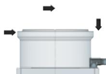
Couple basculant admis au niveau du plateau tournant
