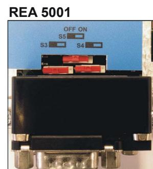
Tenez compte du fait que les interrupteurs sont montés à des endroits différents sur les accessoires REA 5001 et XEA 5001. La caractérisation des interrupteurs et l'affectation des positions des interrupteurs par rapport à la fonction (résistance de charge connectée / déconnectée) sont marquées sur le cache de la platine.
