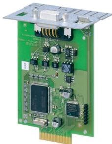
Zubehörteil zur Ankopplung von PROFIBUS DP-V1.
