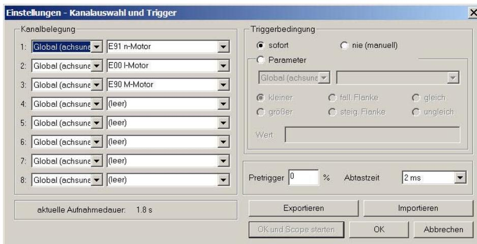
Abb. 8-5 Kanalauswahl und Trigger
