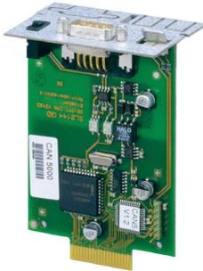
Zubehörteil zur Ankopplung von CAN-Bus.
