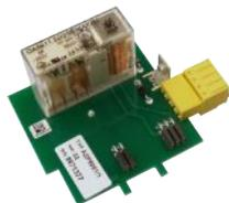
Module optionnel pour réaliser la fonction de sécurité Safe Torque Off (STO) intégrée.
