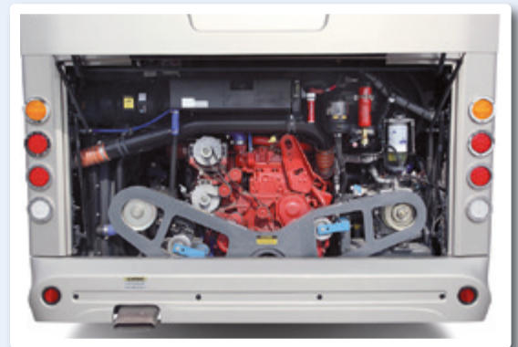
Spannelemente für Riementriebe der Zusatzaggregate bei Bussen.
