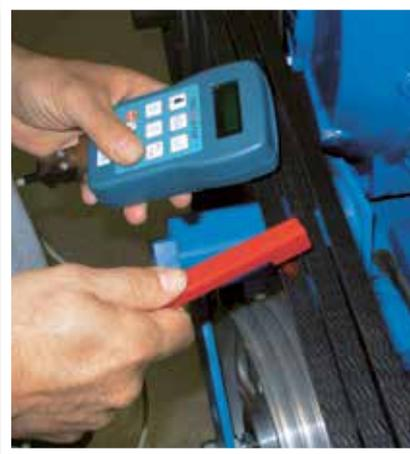
Testeur de fréquence à infrarouge
