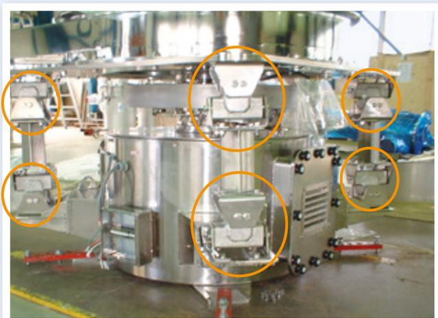
Plansichter-Siebmaschine für Pharmaprodukte auf AK-I 40 Kreuzgelenken
