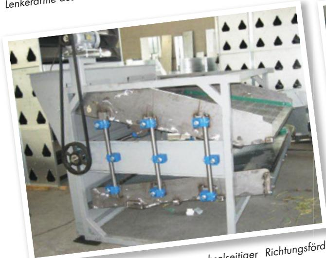
Getreidereinigungsmaschine mit wechselseitiger Richtungsförderung an «Boomerang»-Doppellenker Typ AR 38
