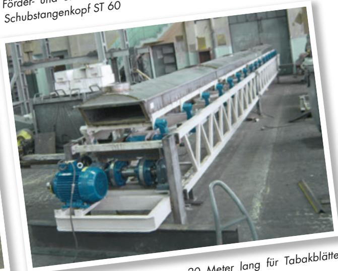
Zweimassen-Schwingfördererinne 20 Meter lang für Tabakblätter mit Doppelschwingen AD-PV 45
