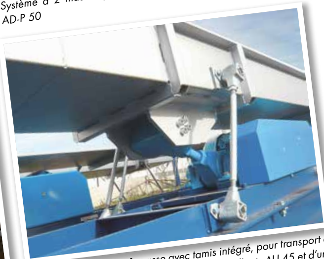
Système à 2 masses à résonance avec bras doubles asymétriques en fonte aluminium
