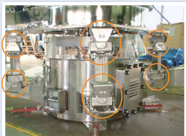
Tamiseur giratoire pour l'industrie pharmaceutique, monté sur 8 éléments AK-I 40 (Inox)
