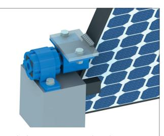
Exemple de connexion en série de 2 éléments DW-C et DK-C (angle de travail  $\pm 60^{\circ}$ ) sur brides BK.
