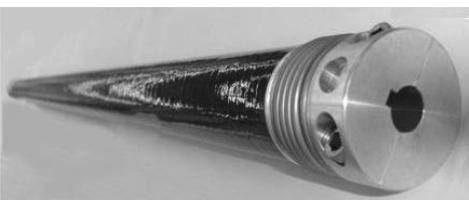
**Hinweis:** Das Zwischenrohr kann in unterschiedlicher Werkstoffausführung sowie in gerichteter und gewuchteter Qualität geliefert werden. Bei hohen Betriebsdrehzahlen über  $2000 \text{ min}^{-1}$  und gleichzeitig großen Baulängen  $L > 2 \text{ m}$  sollte aufgrund der zulässigen biegekritischen Drehzahlen eine Überprüfung durch unsere Techniker erfolgen.
