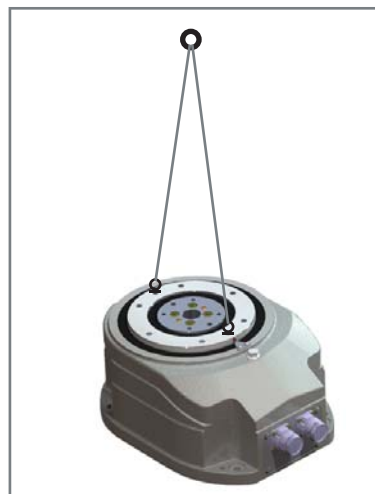
Abb. 4: Unverpackte Maschine transportieren
