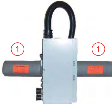
Abb. 13: Schutzabdeckungen über der Horizontalachse
