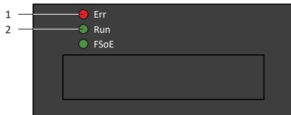
Fig. 88: DEL indiquant l'état EtherCAT
