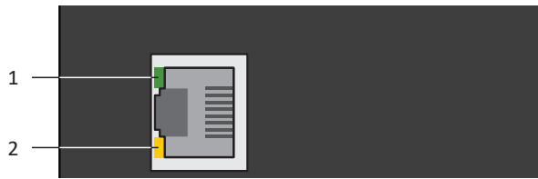
Fig. 93: Diodes électroluminescentes indiquant l'état de la connexion au réseau de maintenance
