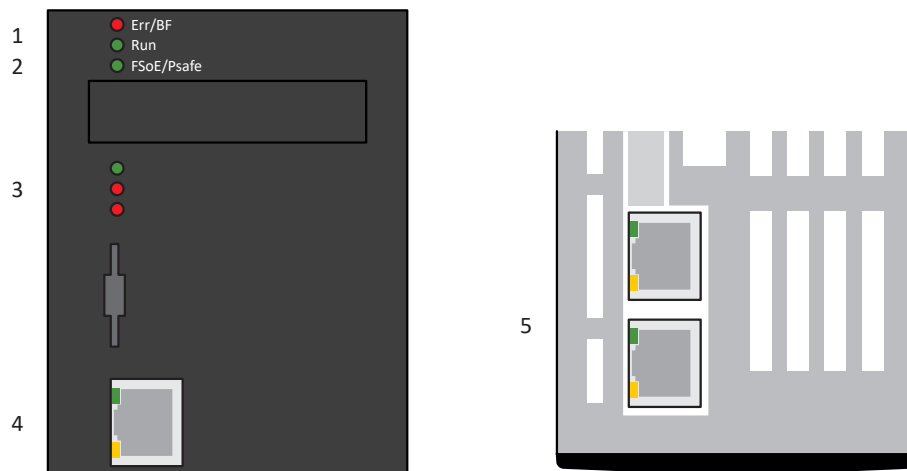
Fig. 86: Positionnement des diodes électroluminescentes de diagnostic sur la face avant et dessus du servo-variateur
