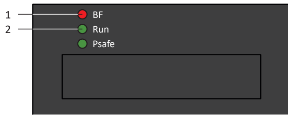
Fig. 91: Diodes électroluminescentes indiquant l'état PROFINET
