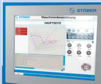
Paramétrage direct sur la machine (Motion Controller MC6 avec panneau à écran tactile)
