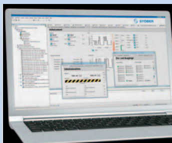
Programmierung des Motion Controllers und der Achsfunktionen mit der Software AutomationControlSuite AS6.
