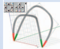
CNC-Funktion Einfache Erstellung von 3D-Bahnkurven.
