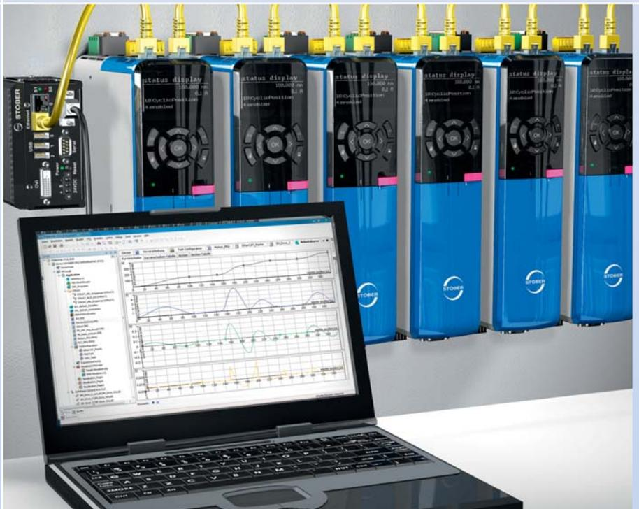
Mise en service centralisée d'une application multiaxe CODESYS
