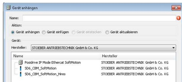
⇒ Sie haben den Antriebsregler in das AS6-Projekt eingebunden. Alle weiteren Einstellungen (Mapping, Adresszuweisungen etc.) werden automatisch durch den Gerätetreiber konfiguriert.
