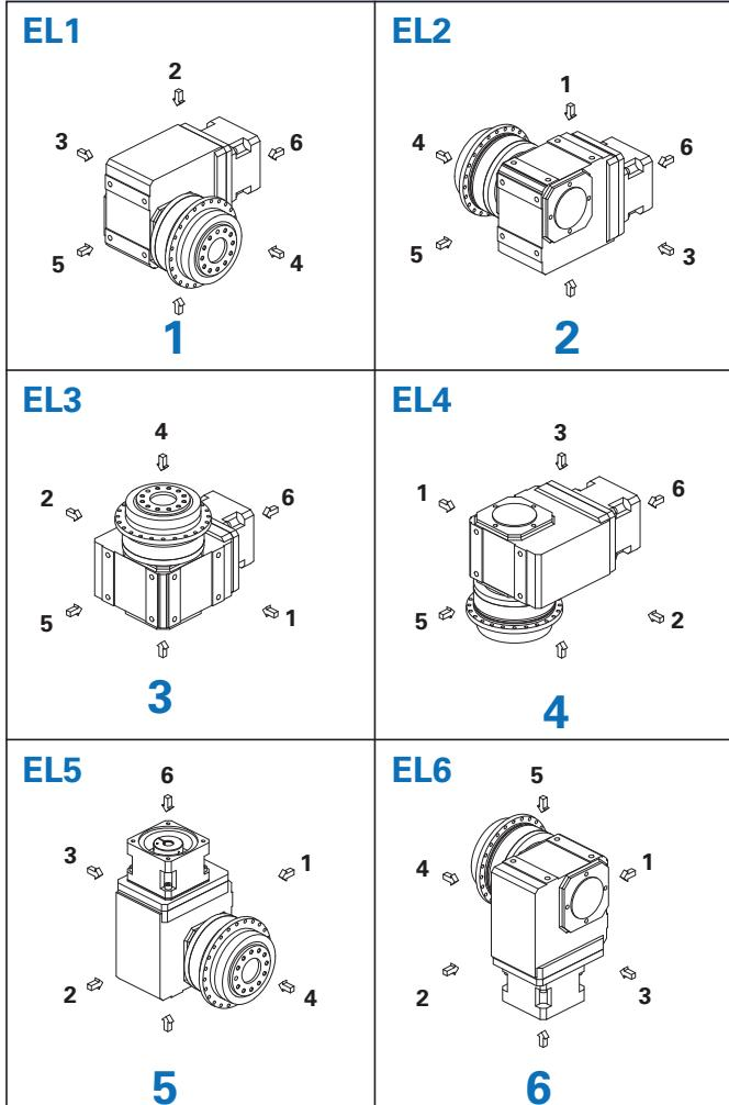
**Die Getriebe** sind mit der auf dem Typschild angegebenen Menge und Art des Schmierstoffs gefüllt. Die Schmierstoff-Füllmenge und der Aufbau der Getriebe sind von der Einbaulage abhängig.
