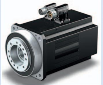
Synchron-Servogetriebemotor mit Hohlwelle. Dieser Flanschhohlwellenantrieb mit voll integriertem Planetengetriebe wurde zur Durchführung von Energie und Medien entwickelt (Übersetzungen von 3 bis 27).
