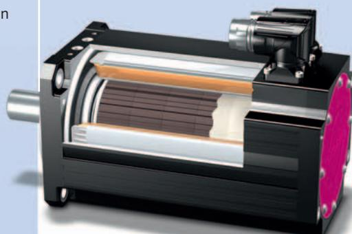
Schnitt: Synchron-Servomotor EZ in Baugröße 5 (5 Rotorsegmente) mit Blick auf die epoxidbeschichteten Permanentmagnete.
