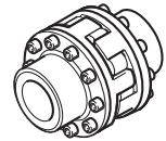
Kupplung mit Flanschnaben (SDD-5 kurz, SDDL-5 lang), aushebbaren Klauenringen und Zwischenring.
